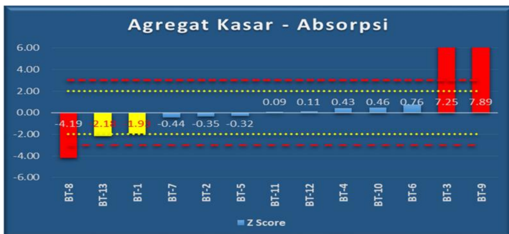
Gambar 5. Evaluasi Z Score Pengujian Absorpsi (Penyerapan) Agregat Kasar
